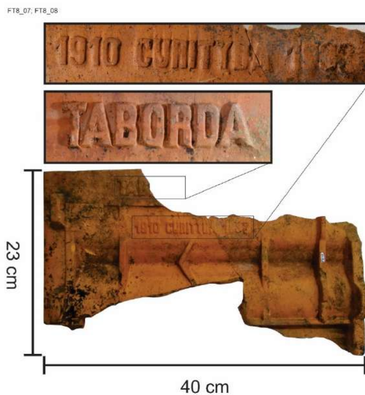
FIGURA 36: TELHA FRANCESA COM DETALHE DA MARCA DO FABRICANTE E ANO DE PRODUÇÃO. FONTE: ESPAÇO ARQUEOLOGIA, 2021.
