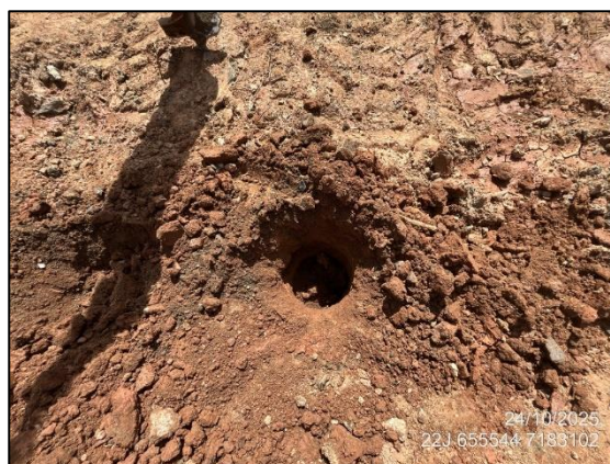
FIGURA 12: SONDAGEM 6 PERFURADA ATÉ 80 CM COM ROCHA NA BASE
