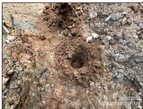
FIGURA 4: SONDAGEM 2 PERFURADA ATÉ 60 CM, ROCHA NA BASE
