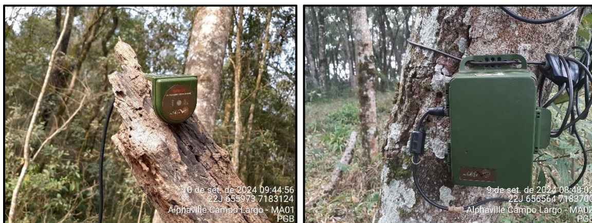
Figura 24 – Gravador bioacústico utilizado na amostragem da mastofauna alada.
