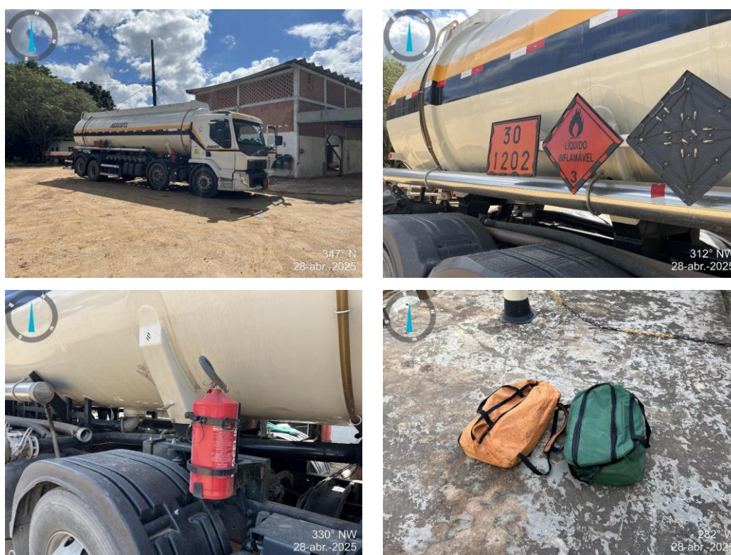
Figura 7 – Fornecimento de combustível, kit de mitigação ambiental, extintores e placas de sinalização
