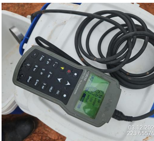
Figura 3. Sonda multiparâmetros para medição de parâmetros in situ .
