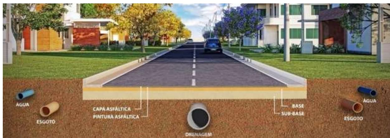
**Figura 4.8 – Sistema de drenagem na via pública normalmente utilizado em empreendimentos Alphaville**
