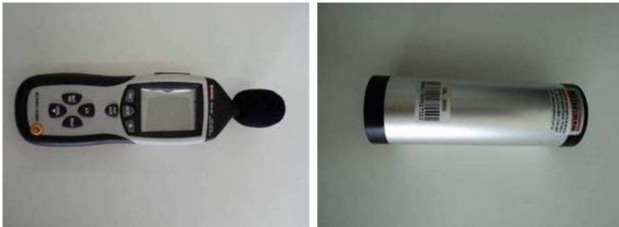
**Figura 6.5 – Decibelímetro Instrutherm, modelo DEC-490 e Calibrador de decibelímetro – Instrutherm, modelo CAL – 3000, respectivamente**
