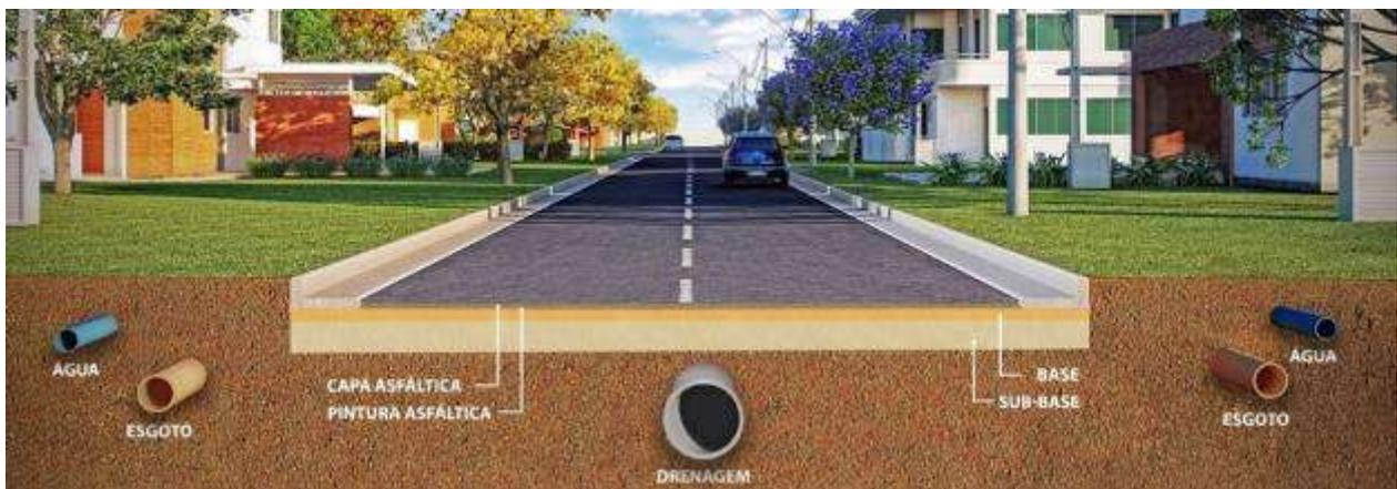
**Figura 3.16 – Sistema de drenagem na via pública normalmente utilizado em empreendimentos Alphaville**
